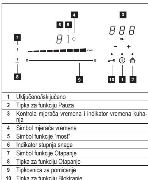
Zone za kuhanje mogu se aktivirati pritiskom na odgovarajuću kliznu tipkovnicu. Broj se bali jače kako bi potvrdio radnju. Također je moguće aktivirati zone za kuhanje jednostavnim postavljanjem posude na zonu za kuhanje. Ploča za kuhanje
